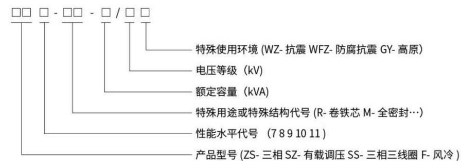
◎ 50kVA~1600kVA 三相双绕组无励磁调压配电变压器
