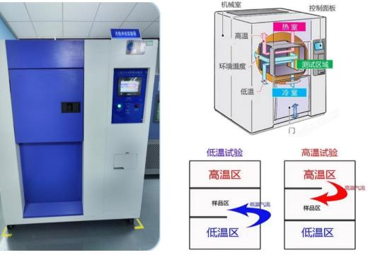
Model: KM-80L-CJ-40、Volume:80L、 Humidity Range:-55°C—150°C 、 Slope:  $\leq$  5Min 、 Control Stability: ±0.2°C
