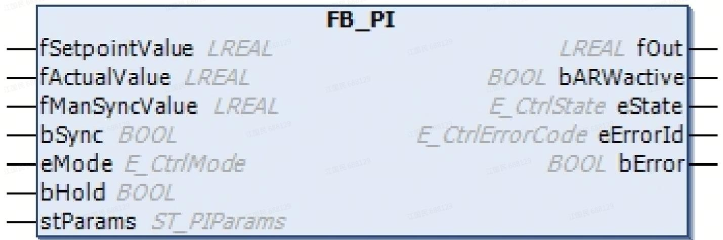
控制器功能块 **FB\_PI** 具有多个输入和输出，具体描述如下。所有控制器的参数均通过结构体传递给功能块。
