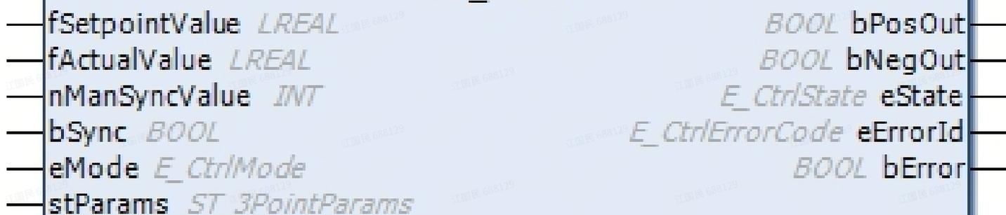
控制器功能块 **FB\_3Point** 具有多个输入和输出，具体描述如下。所有控制器的参数均通过结构体传递给功能块。
