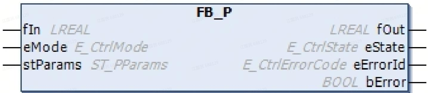
控制器功能块 **FB\_P** 具有多个输入和输出，具体描述如下。所有控制器的参数均通过结构体传递给功能块。
