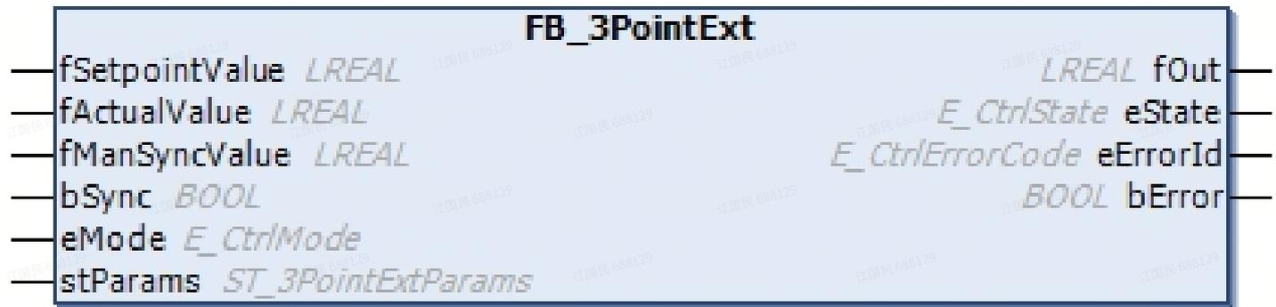
控制器功能块 **FB\_3PointExt** 具有多个输入和输出，具体描述如下。所有控制器的参数均通过结构体传递给功能块。
