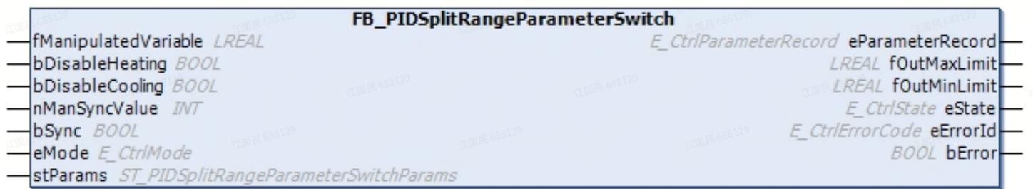
控制器功能块 **FB\_PIDSplitRangeParameterSwitch** 具有多个输入和输出，具体描述如下。所有控制器的参数均通过结构体传递给功能块。
