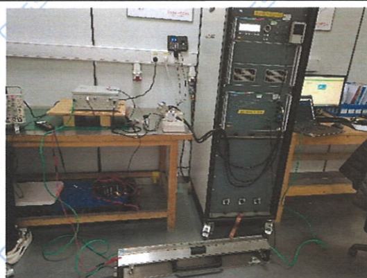
图 26 信号线-EFT 测试布置
