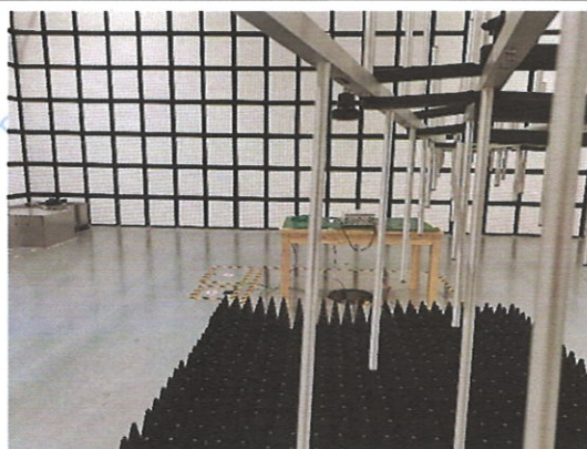
图 11 80MHz-1GHz 垂直场强布置
