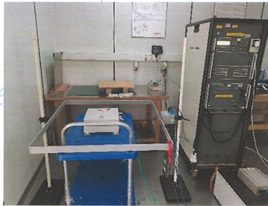
图 22 工频磁场抗扰测试布置
