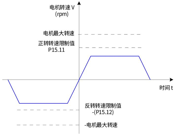
图 4-55 P15.09=0 速度限制曲线图
