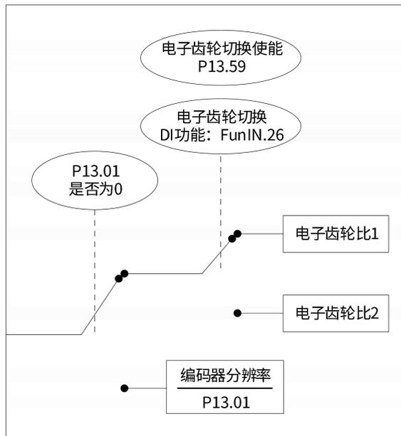
图 3-7 电子齿轮比设定操作流程
