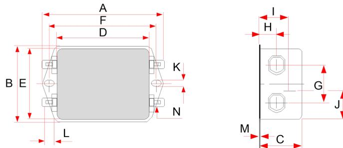
图 2-44 FN 2090 系列 1~20A 滤波器尺寸图(单位: mm)
