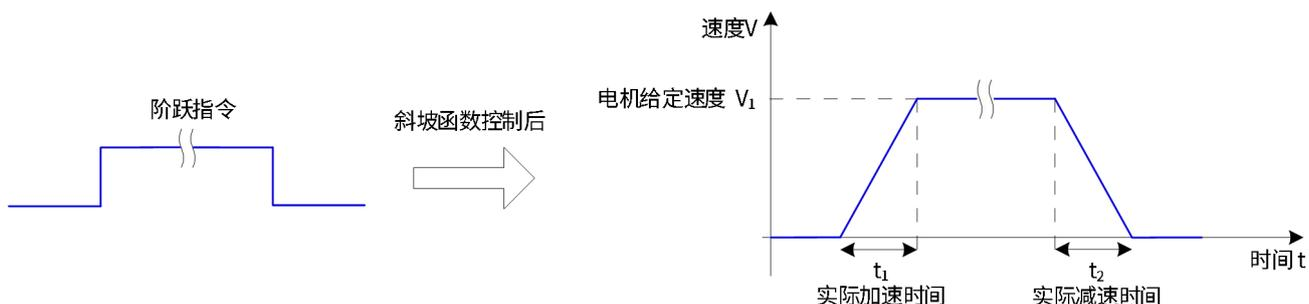
图 4-28 斜坡函数定义示意图
