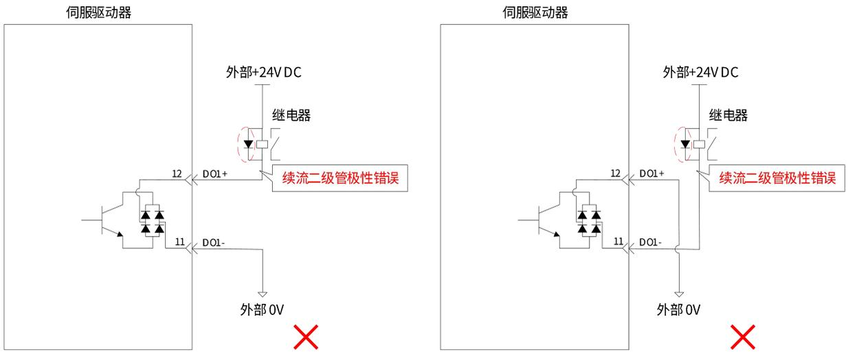
图 2- 20 数字量输出接线示意图（继电器输入，错误接线）
