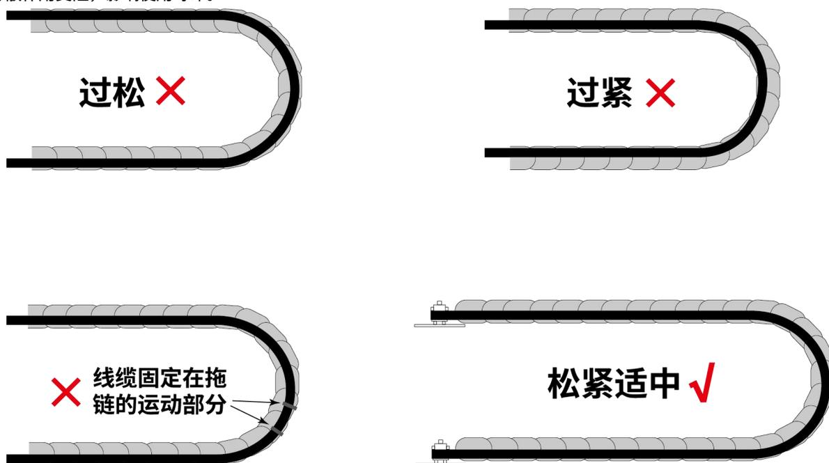
图 1-8 导轨电缆的配线状态
