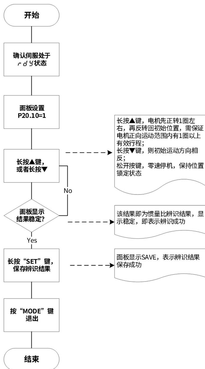
图 5-4 面板操作惯量辨识流程图
