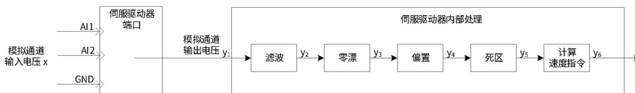
图 4-21 伺服驱动器 AI 处理流程
