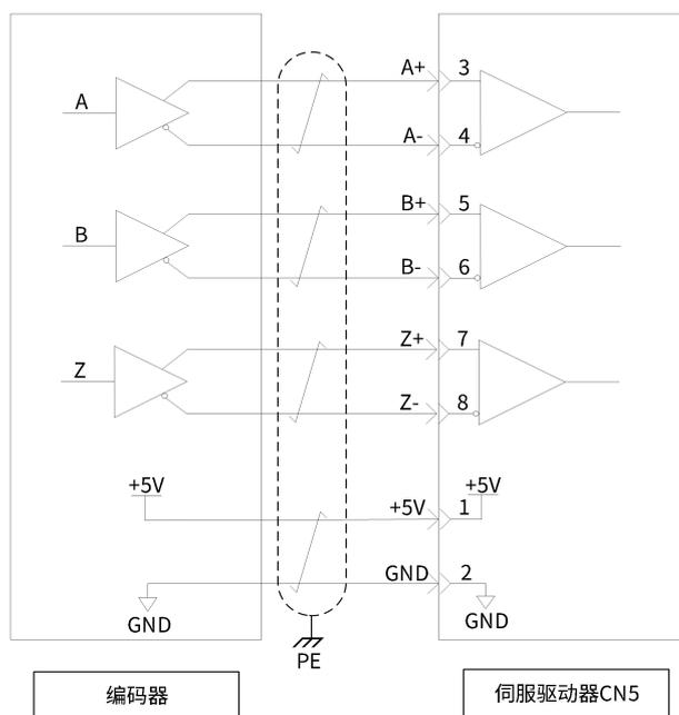
图 2-38 全闭环编码器差分信号输入
