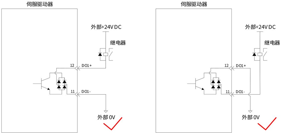
图 2-19 数字量输出接线示意图（继电器输入，正确接线）
