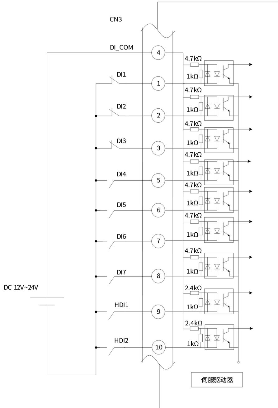
图 2-15 数字量输入接线
