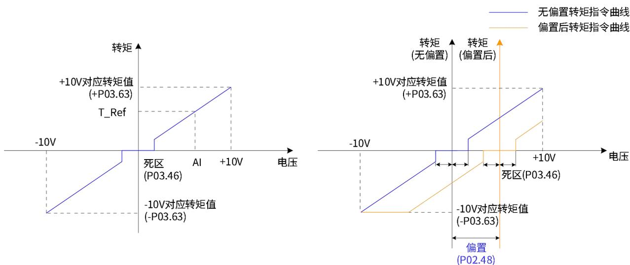
图 4-41 无偏置 AI2 示意图（左）&偏置后 AI2 示意图（右）
