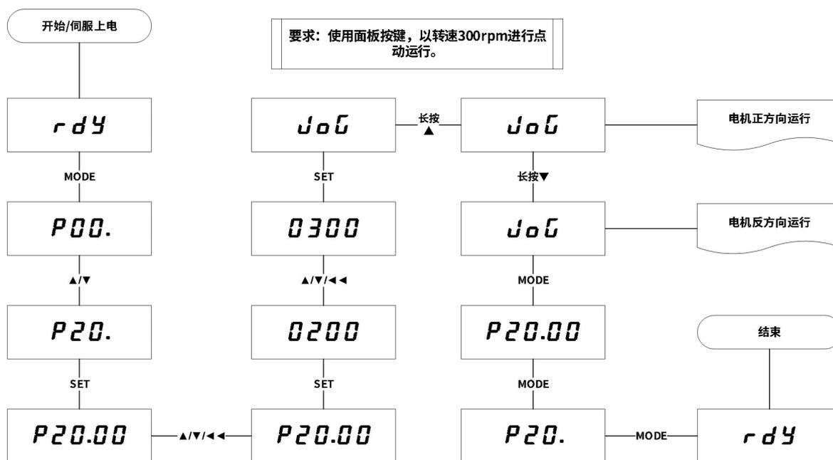
图 3-16 面板点动运行示例操作与显示图
