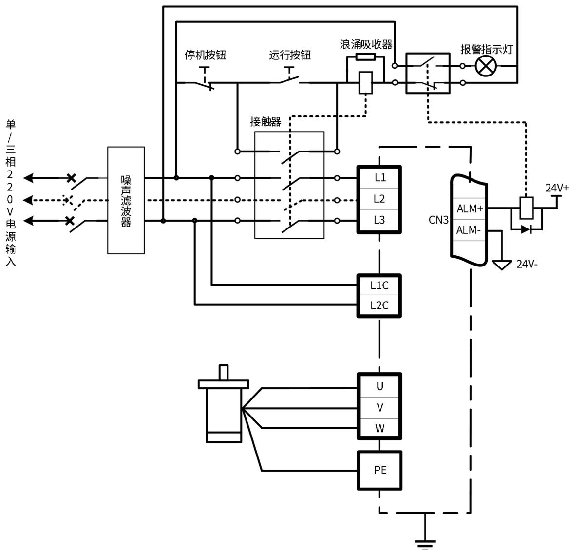
图 2-7 SIZE B 主电路配线示例
