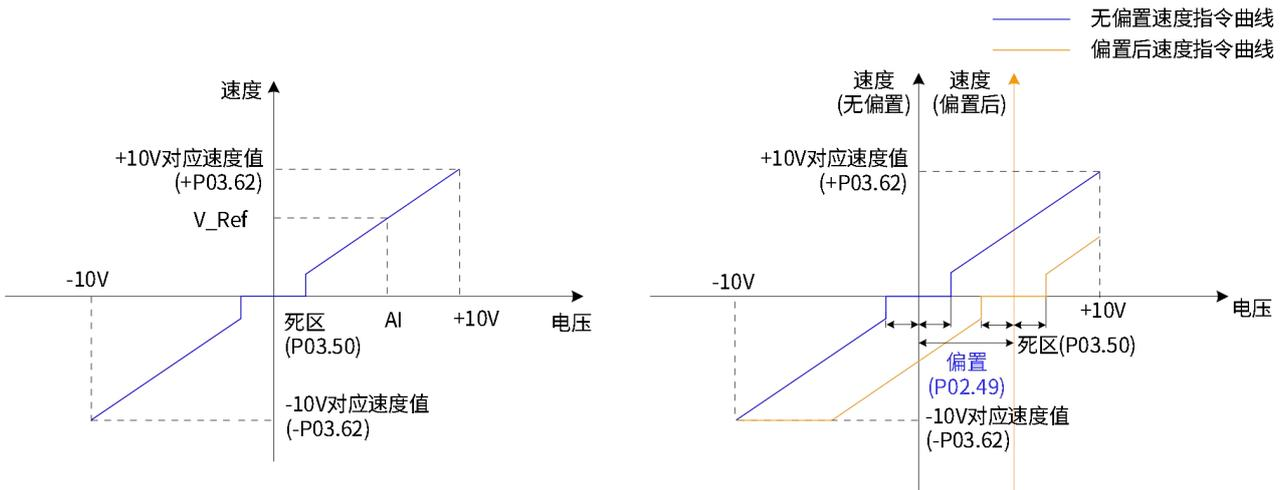
图 4-23 无偏置 AI2 示意图 (左) & 偏置后 AI2 示意图 (右)
