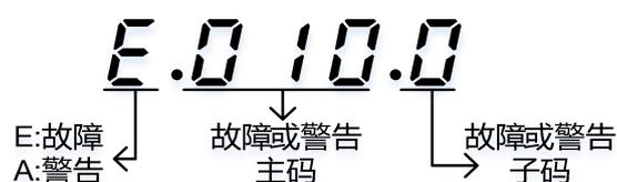
图 6- 1 故障显示示例
