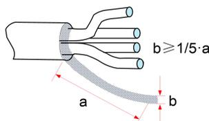
图 2-48 电机线缆屏蔽引出示意图
