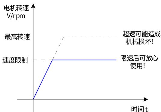
图 4-53 转矩模式速度限制示意图
