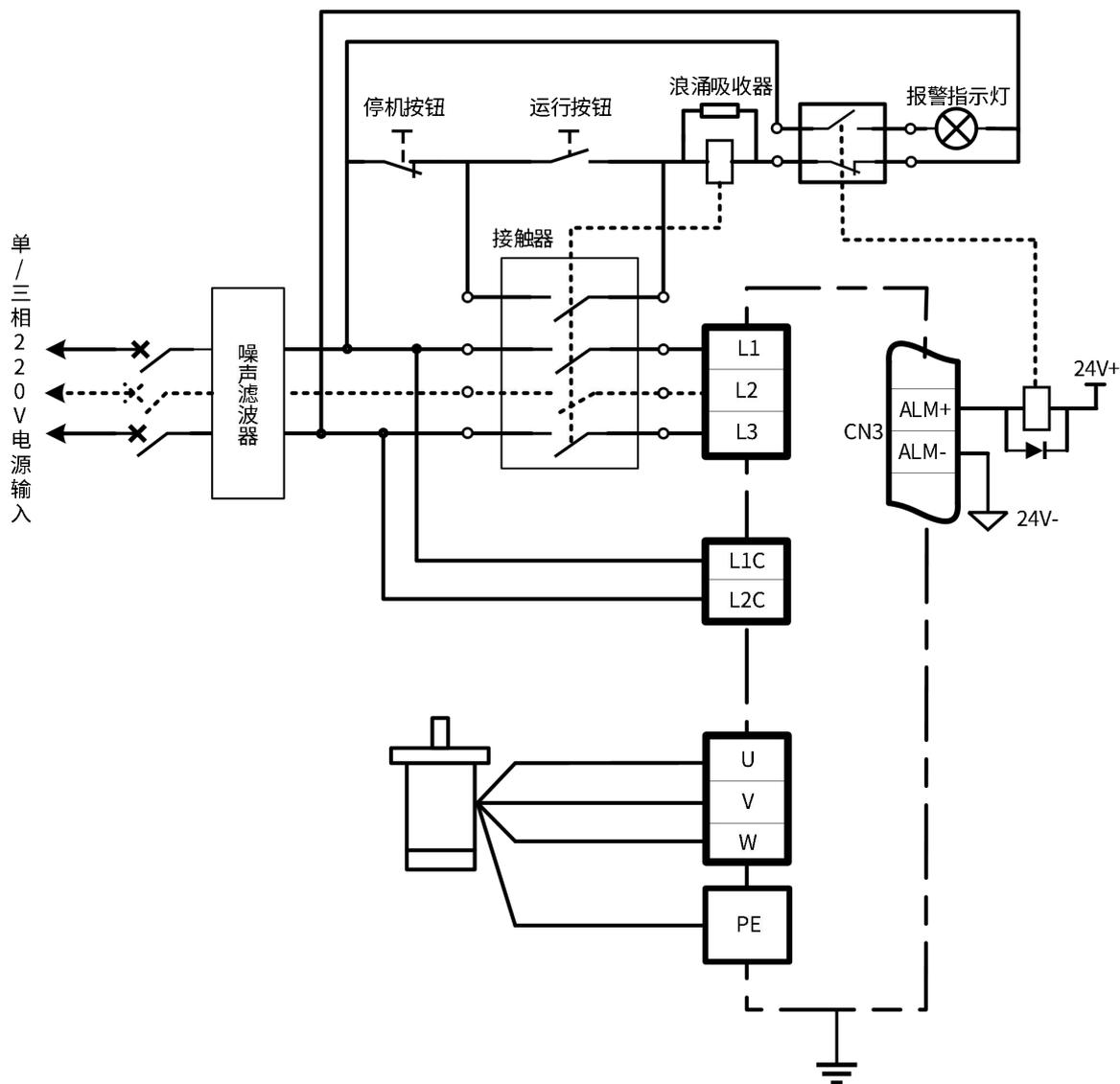
图 2-6 SIZE A 主电路配线示例
