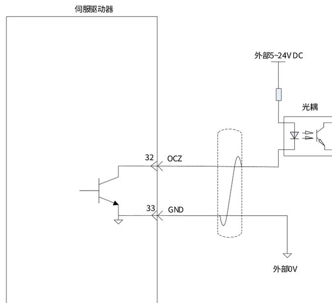
图 2-25 编码器 Z 相集电极开路输出接线
