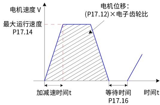
图 4-9 第 1 段电机运行曲线
