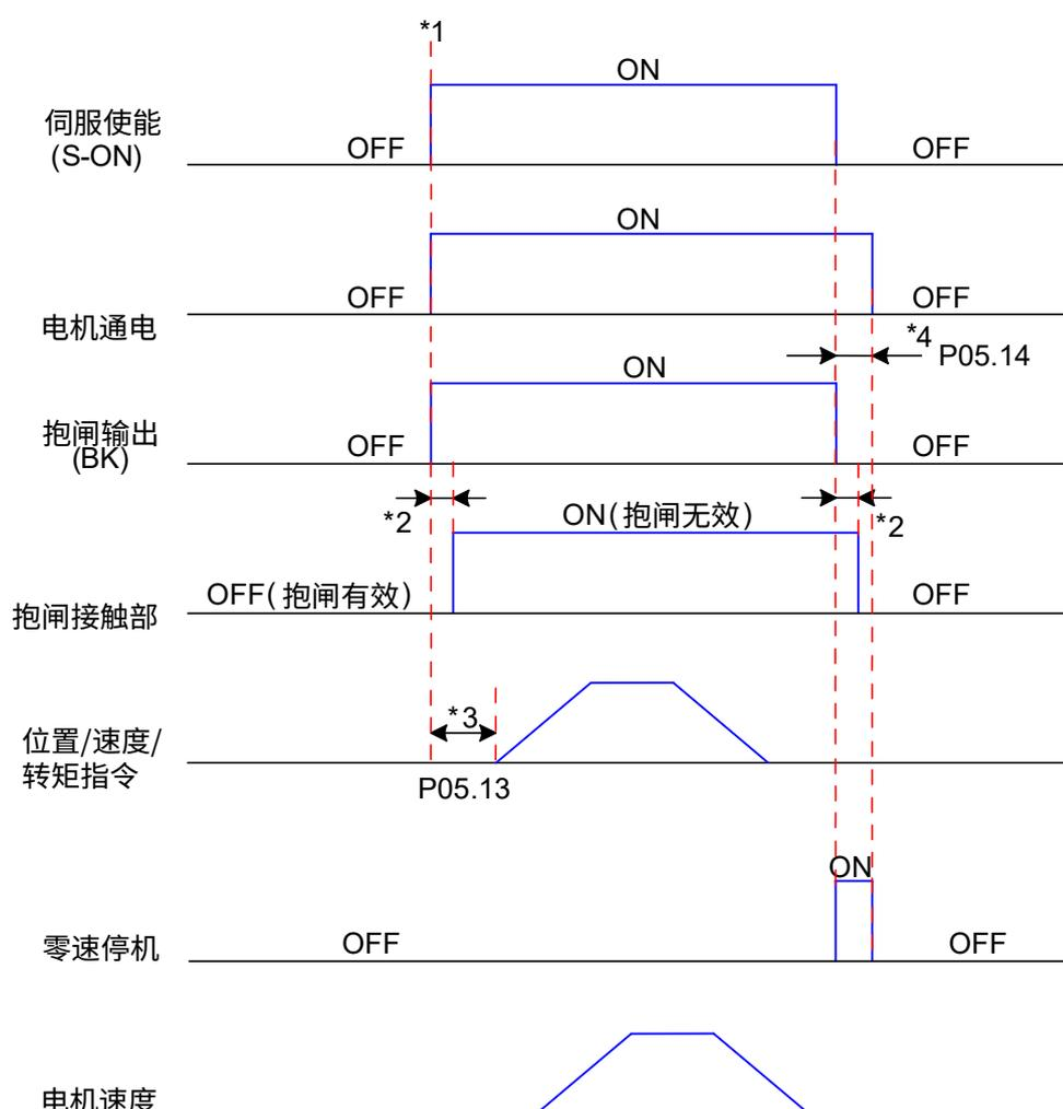
图 3-3 电机静止时抱闸时序图
