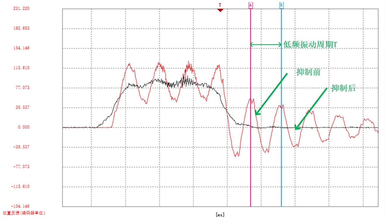
图 5-32 长悬臂负载振动频率获取及抑制前后效果对比
