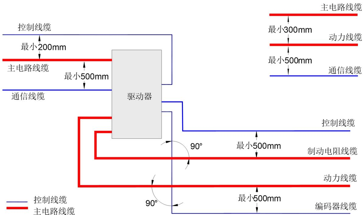
图 2-49 推荐的线缆布置图
