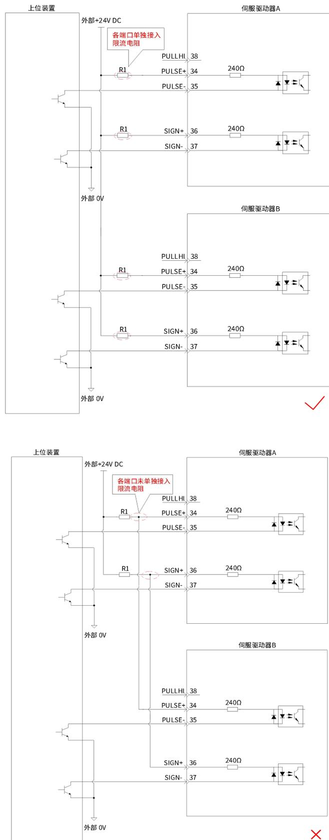
图 2-33 低速脉冲指令输入接线示意图 (错误接法 5)
