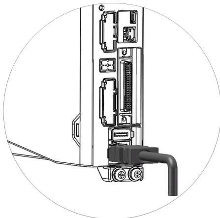
图 1- 7 伺服驱动器线缆走线要求示意图
