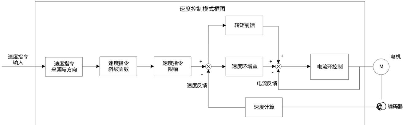
图 4-16 速度控制框图
