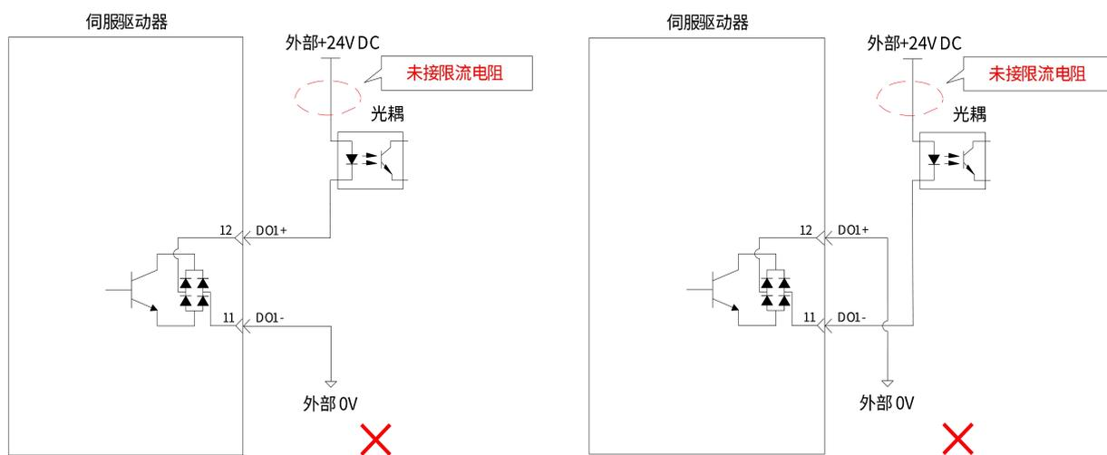
图 2- 22 数字量输出接线示意图 (光耦输入, 错误接线)
