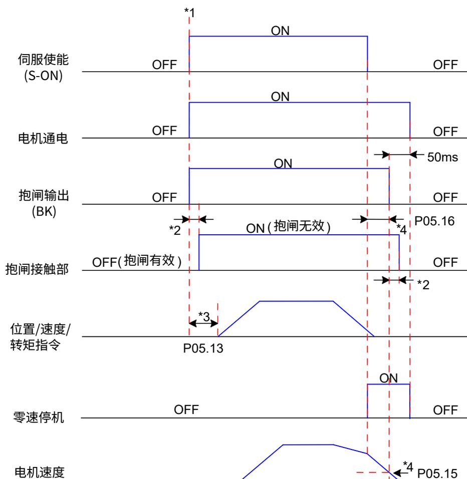
图 3-4 电机运动时抱闸时序图
