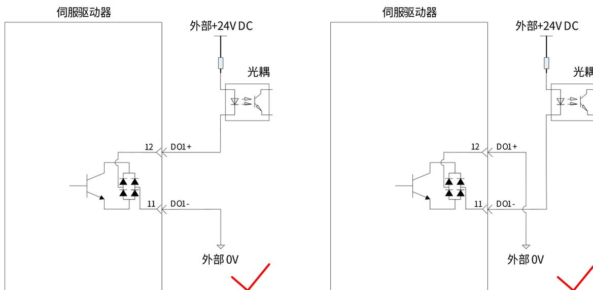
图 2- 21 数字量输出接线示意图 (光耦输入, 正确接线)
