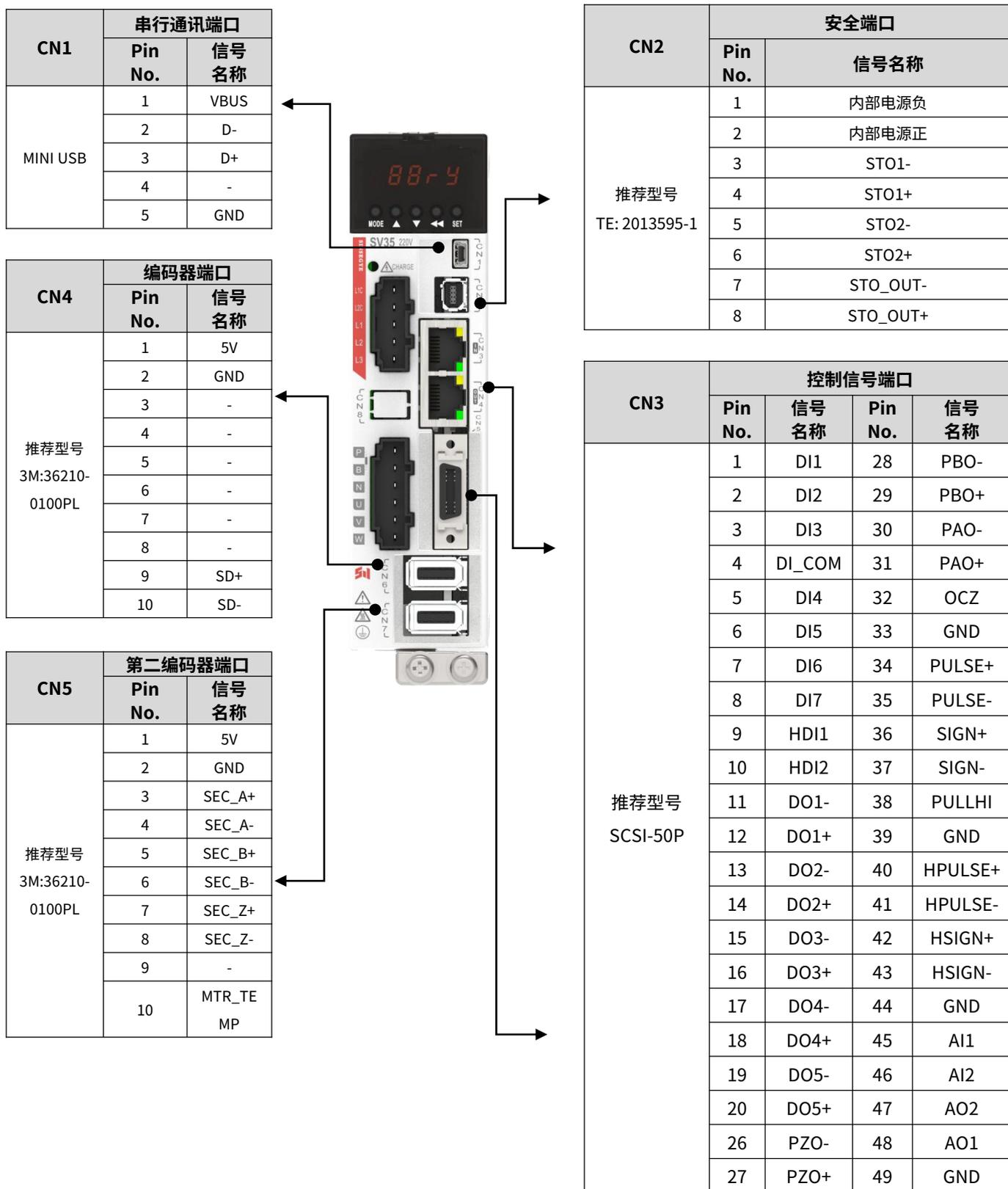
图 2-5 伺服驱动器端口定义
