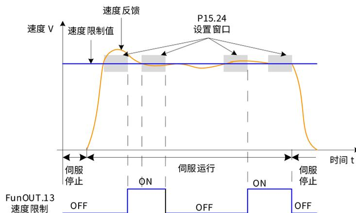
图 4-57 速度限制 DO 输出波形举例
