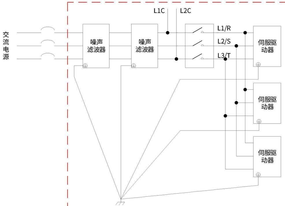
图 2-42 噪声滤波器串联使用安装与接地示意图
