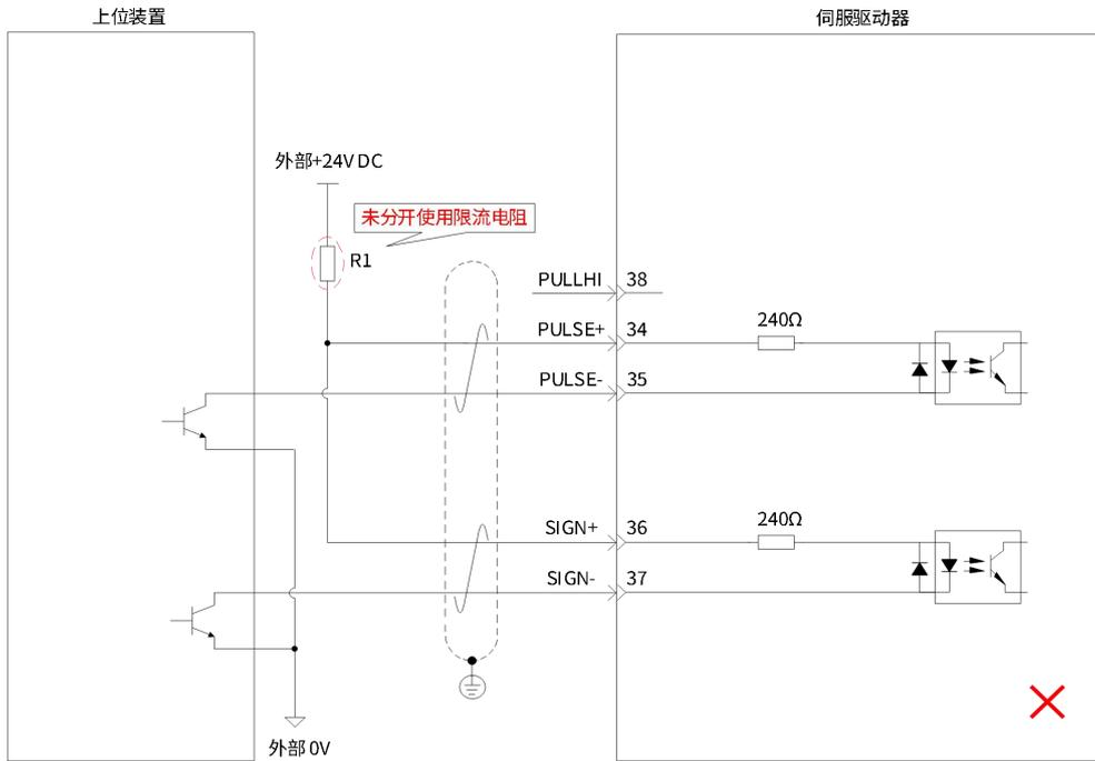
图 2-30 低速脉冲指令输入接线示意图 (错误接法 2)
