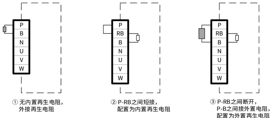
图 2-11 再生电阻接线
