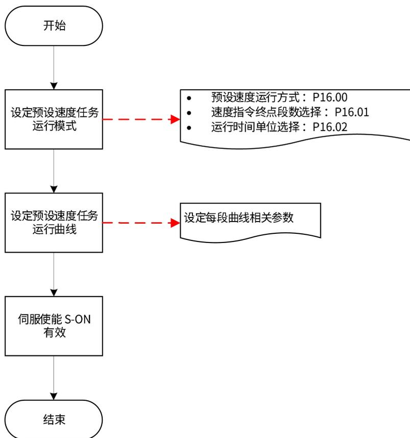
图 4-25 预设速度任务设置流程图
