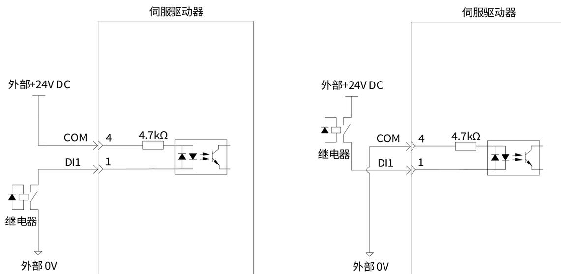
图 2-16 数字量输入接线示意图 (继电器输出)
