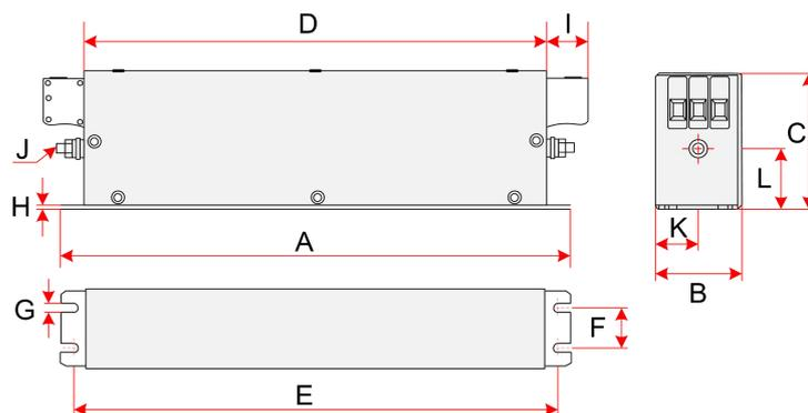
图 2-45 FN3258 系列 7~30A 滤波器尺寸图(单位: mm)
