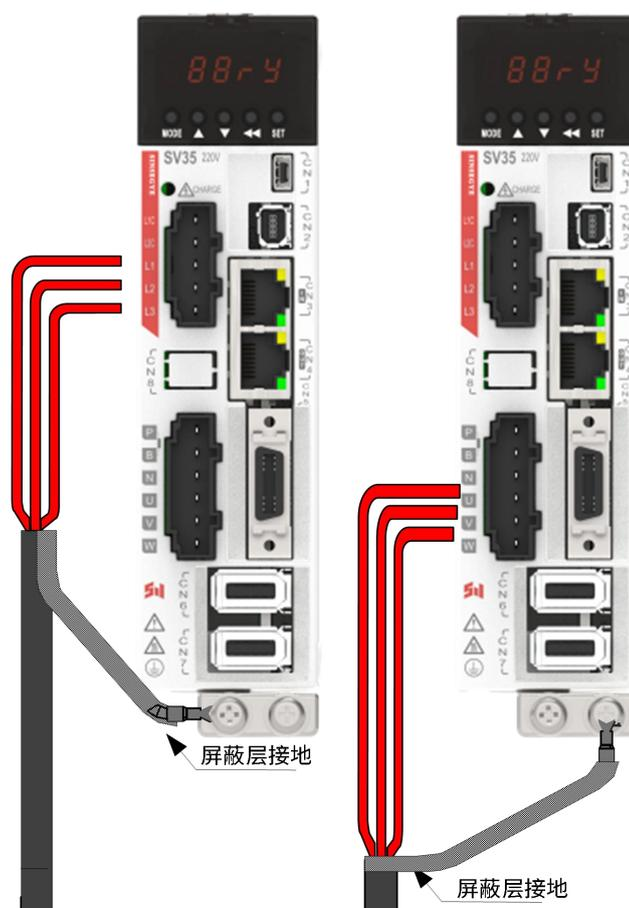
图 2-47 输入/输出侧动力线缆屏蔽层接线
