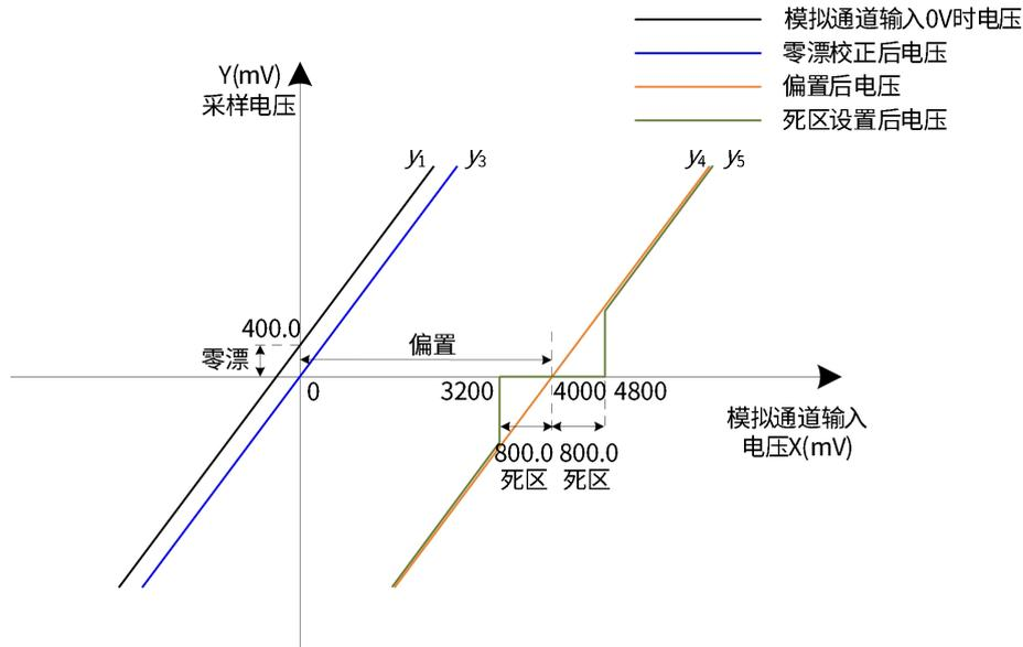
图 4- 40 伺服驱动器 AI 处理对应采样电压举例
