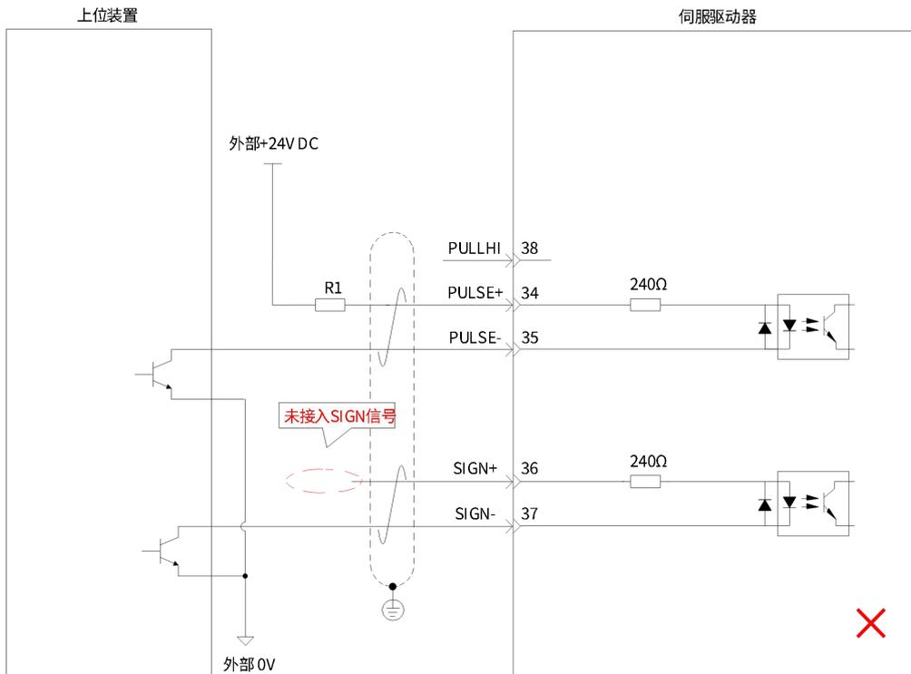
图 2-31 低速脉冲指令输入接线示意图 (错误接法 3)
