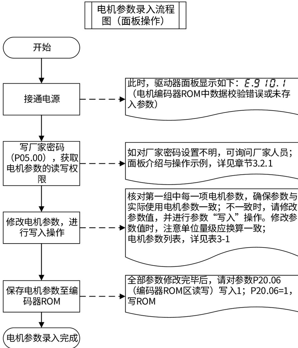
图 3-1 电机参数录入面板操作流程
