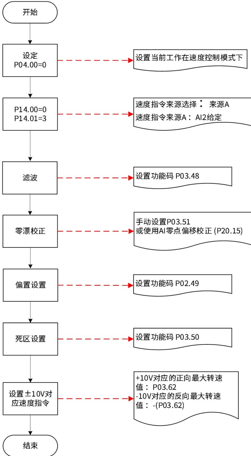
图 4-20 模拟量电压速度指令操作流程
