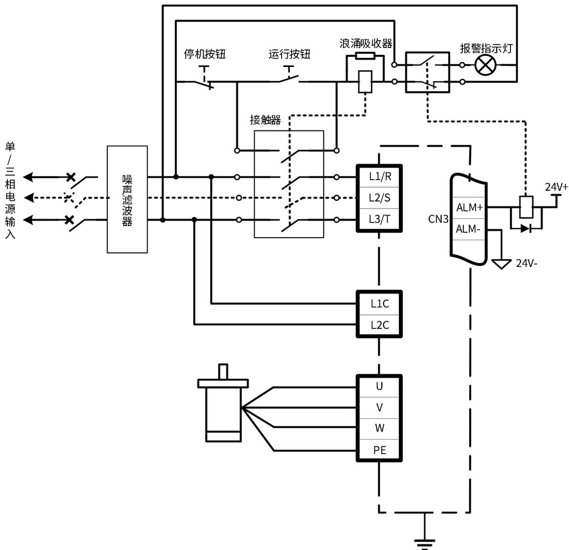
图 2-8 SIZE C 主电路配线示例
