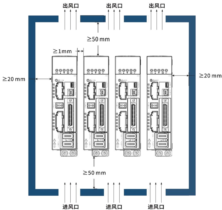
图 1- 6 伺服驱动器安装示意图（紧凑安装时）
