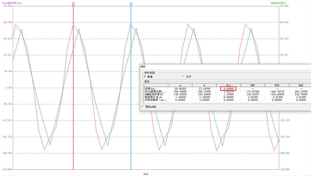
图 5-22 后台软件测试共振频率截图
