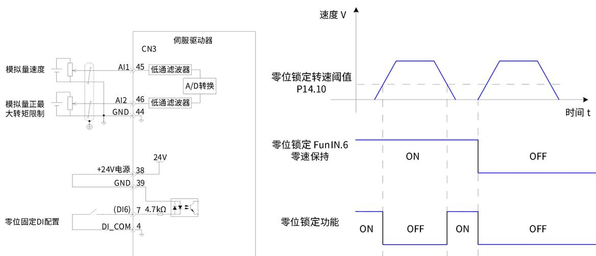
图 4-29 零位锁定相关配线与波形图
