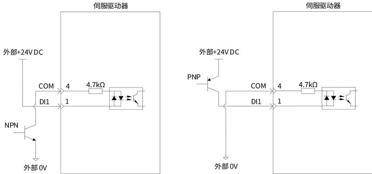
图 2-17 数字输入接线示意图 (集电极开路)
