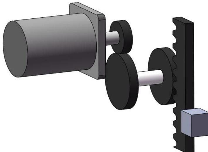
图 5-27 齿轮齿条传动链
