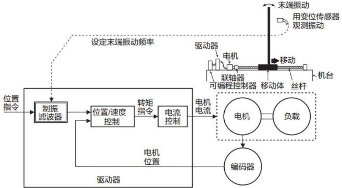
图 5-31 长悬臂负载振动频率获取及抑制方法
