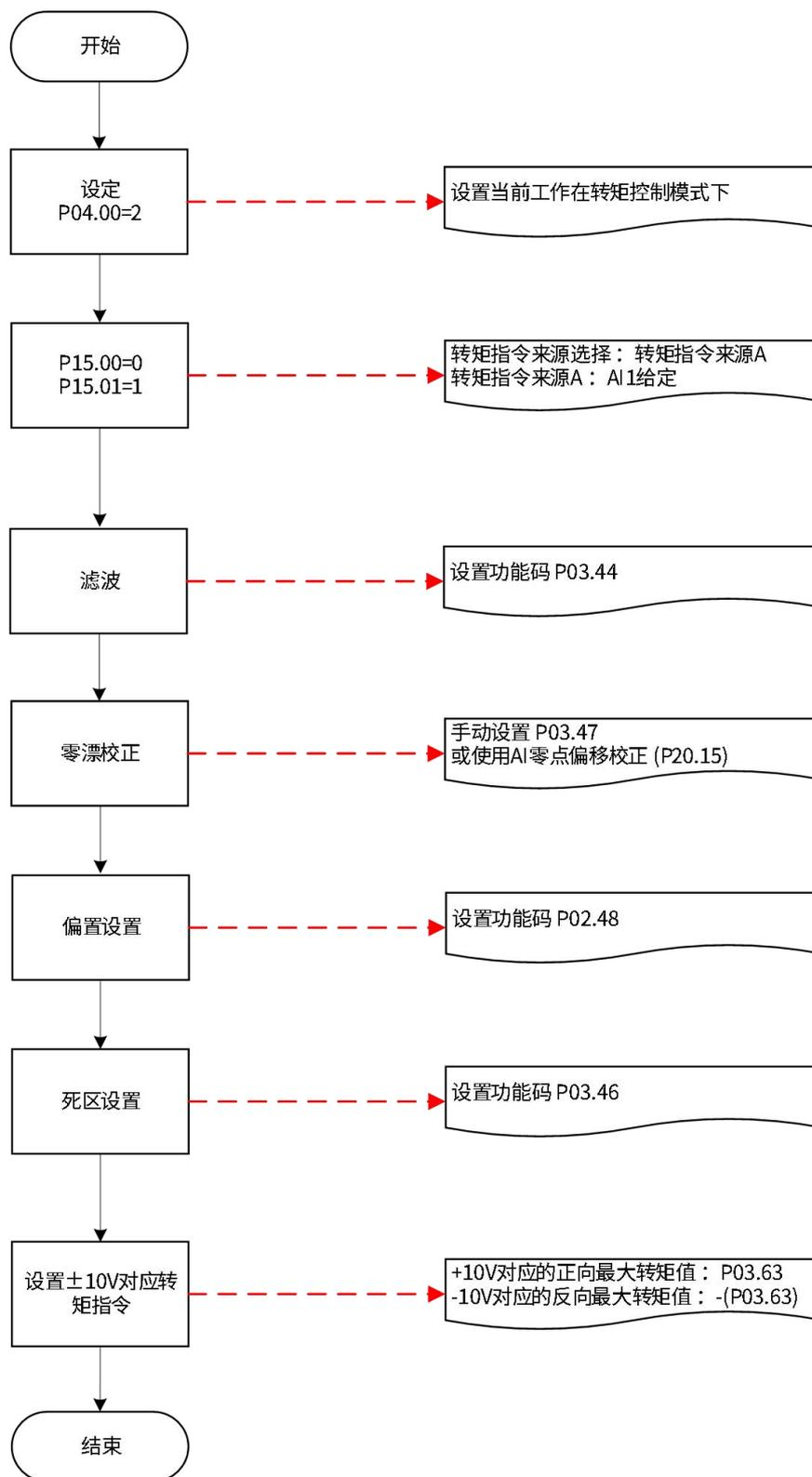
图 4- 38 模拟量电压转矩指令操作流程
