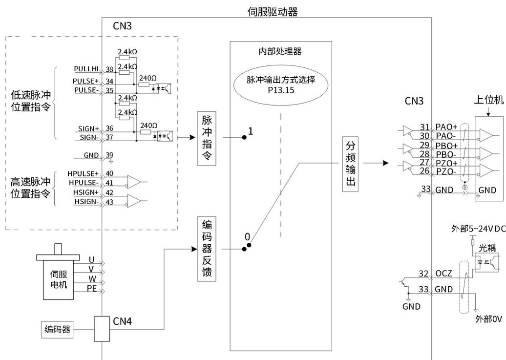
图 4- 60 分频输出原理示意图
