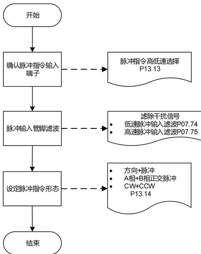
图 4- 5 脉冲指令来源设置流程
