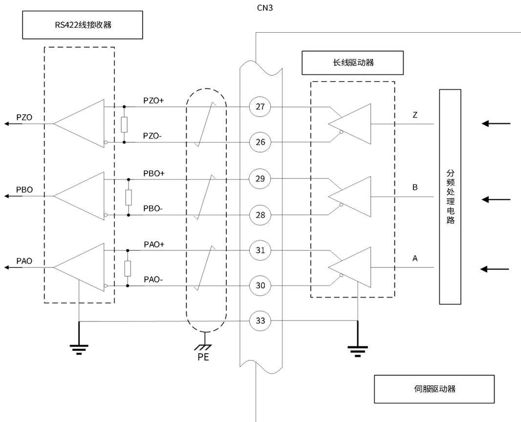
图 2-23 分频输出接线
