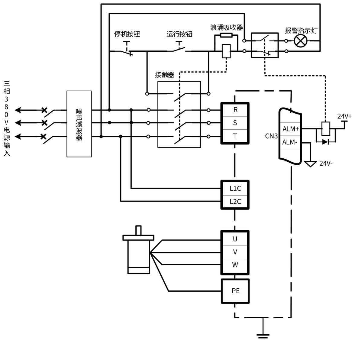
图 2-9 SIZE D 主电路配线示例
