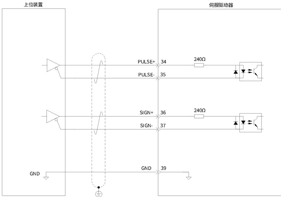
图 2-26 低速脉冲指令输入接线示意图（差分方式）
