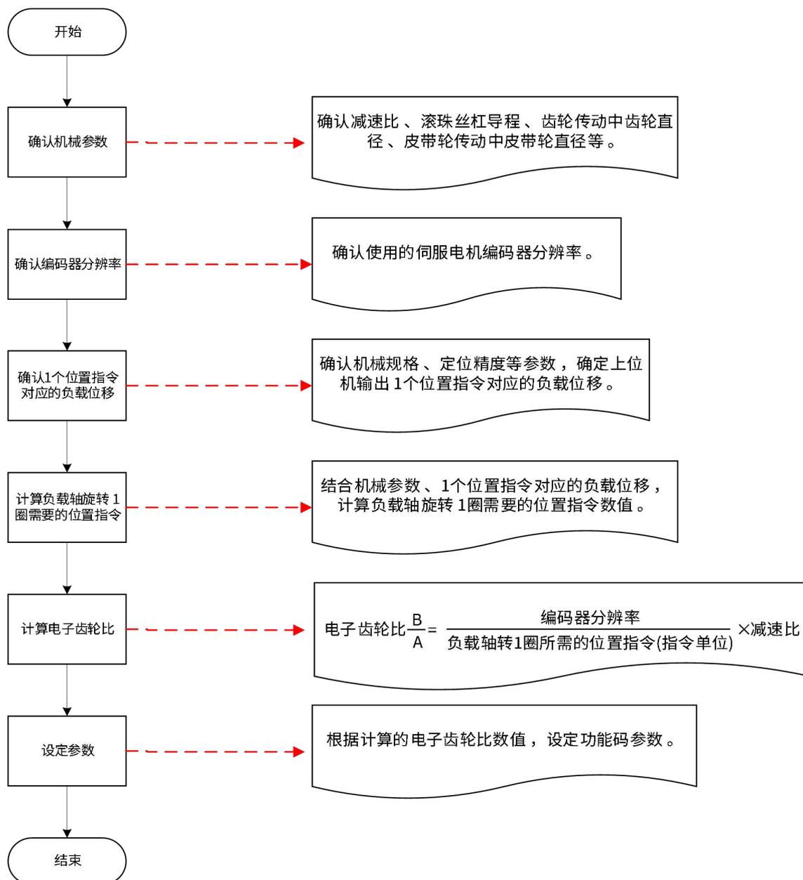
图 3-6 电子齿轮比设定步骤
