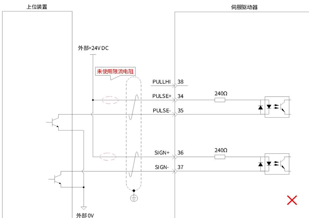
图 2-29 低速脉冲指令输入接线示意图（错误接法 1）
