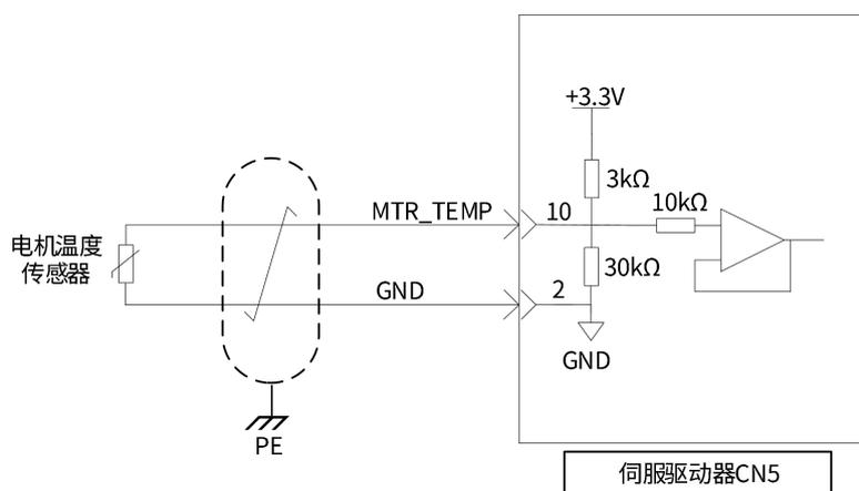
图 2-39 电机温度传感器接线图
