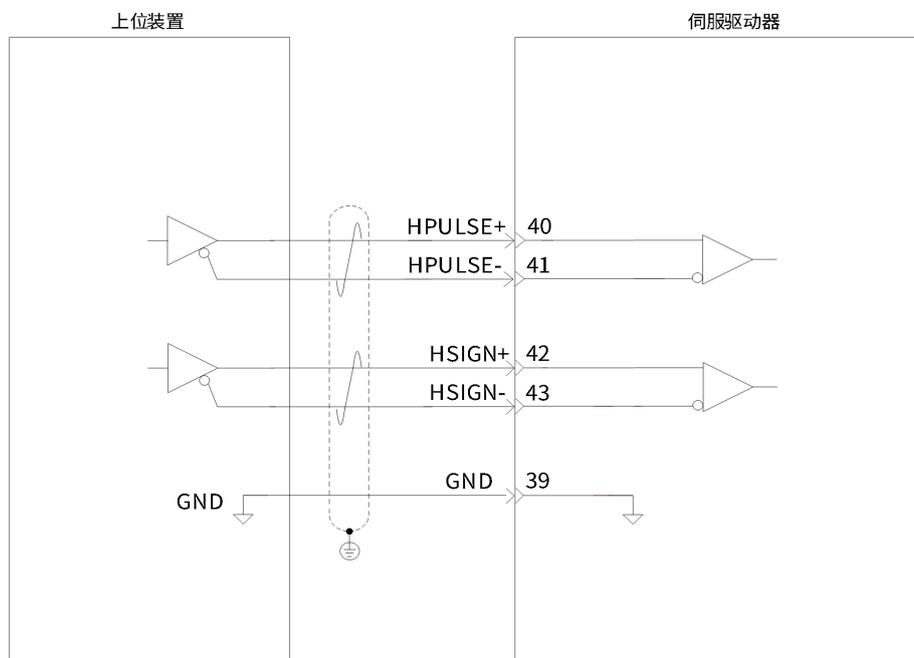
图 2-34 高速脉冲指令输入接线示意图
