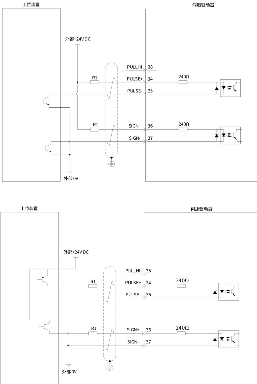
图 2-28 低速脉冲指令输入接线示意图 (集电极开路方式-外部电阻)
