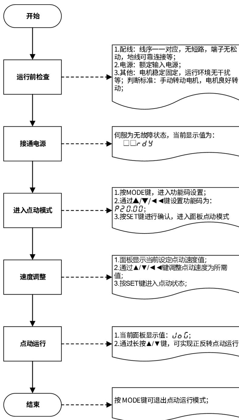
图 3-17 面板点动运行操作流程
