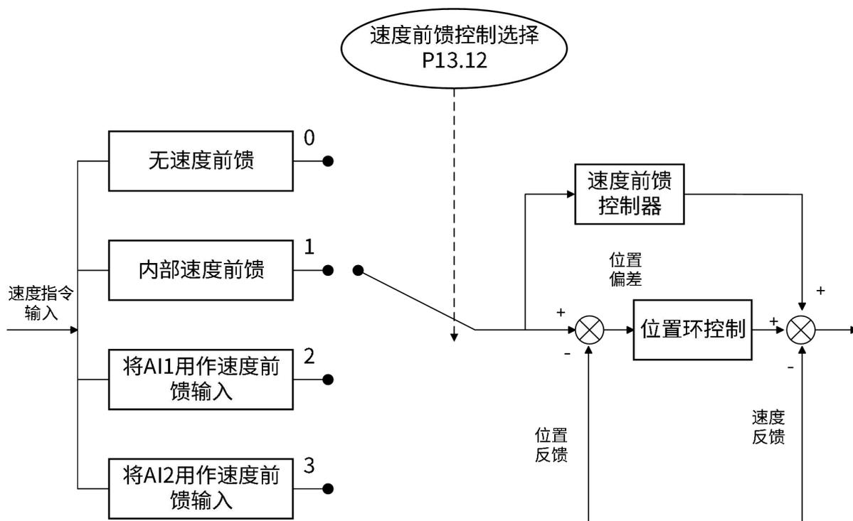
图 5-12 速度前馈控制框图
