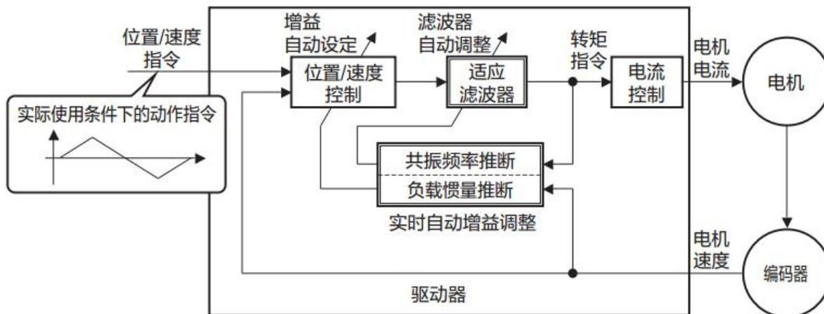
图 5-21 自适应振动抑制原理框图
