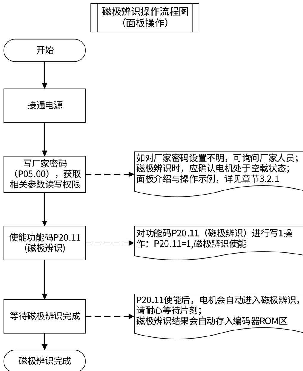
图 3-2 磁极辨识操作流程
