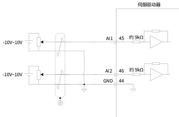
图 2-35 模拟量输入接线示意图
