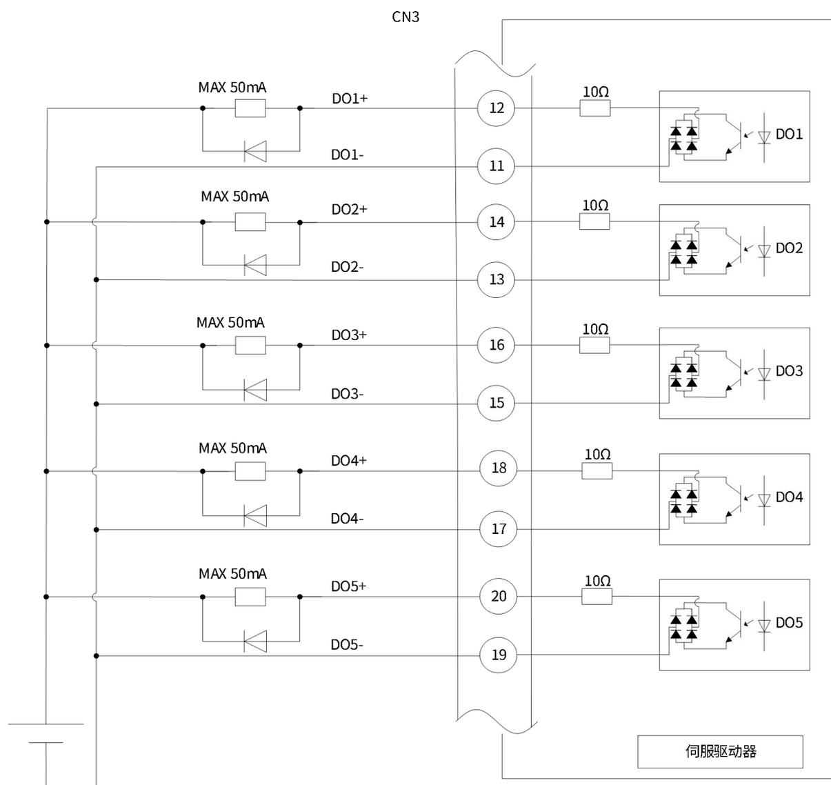
图 2-18 数字量输出接线
