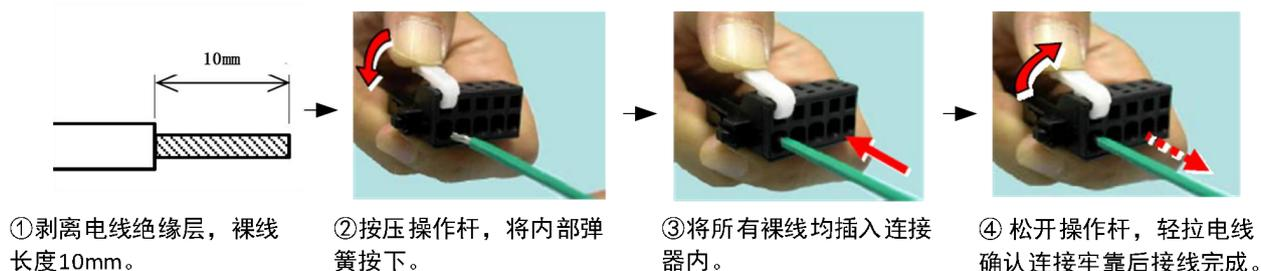
图 2-5 卡簧式端子接线方法
