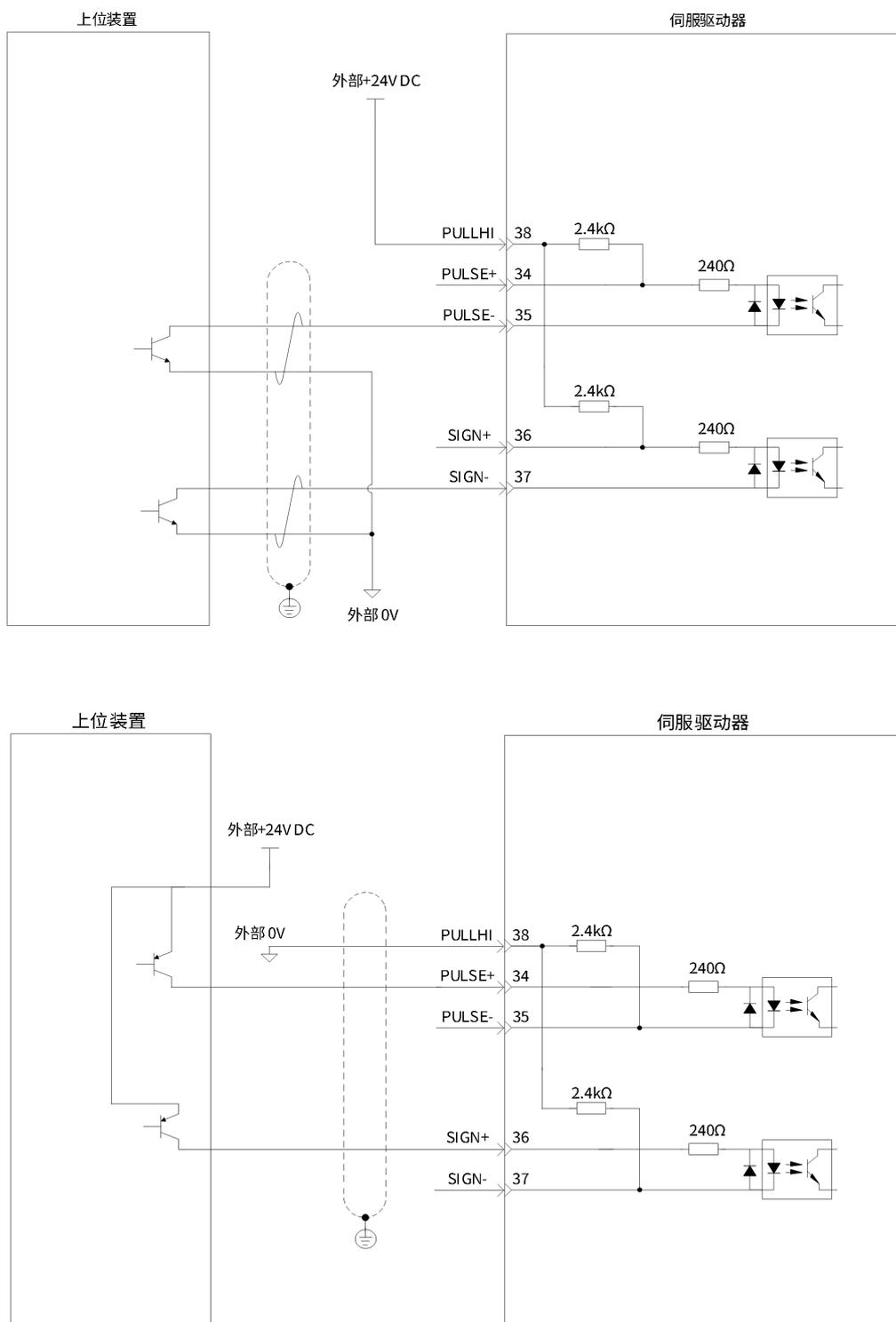
图 2-27 低速脉冲指令输入接线示意图（集电极开路方式-使用内部电阻）
