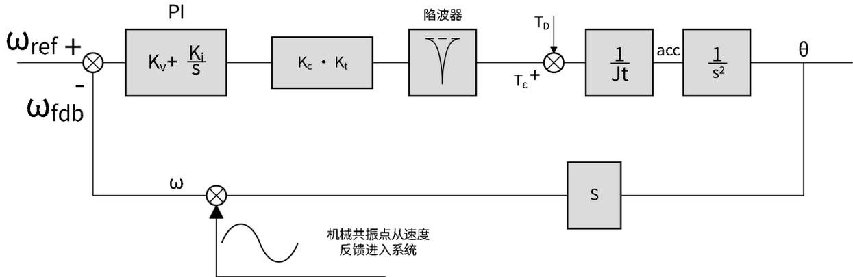
图 5-20 共振抑制控制框图
