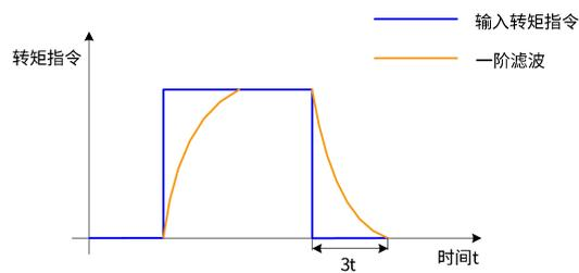
图 4-42 矩形转矩指令一阶滤波示意图
