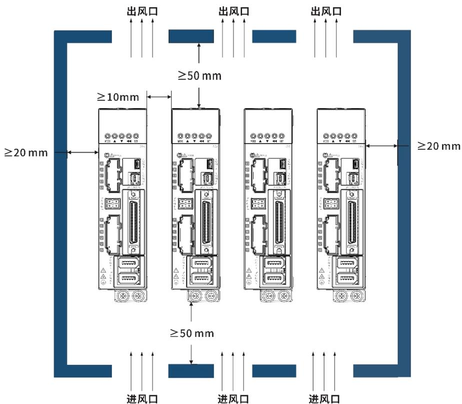
图 1-5 伺服驱动器安装示意图（保留间距安装时）
