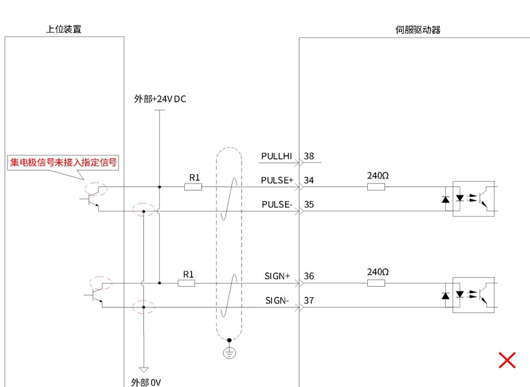
图 2-32 低速脉冲指令输入接线示意图 (错误接法 4)
