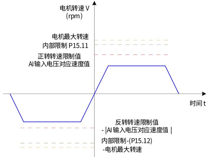
图 4-56 P15.09=2 速度限制曲线图
