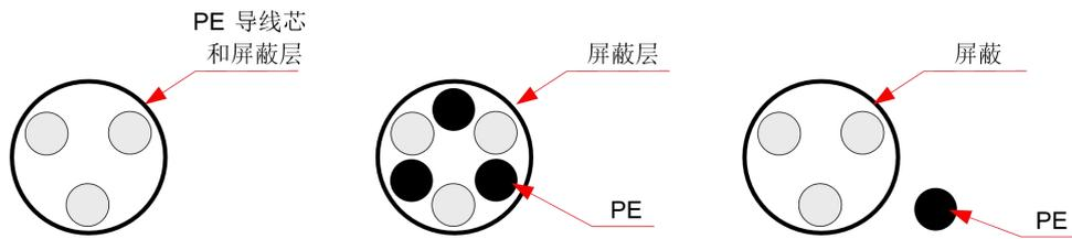
图 2-46 推荐的动力电缆类型
