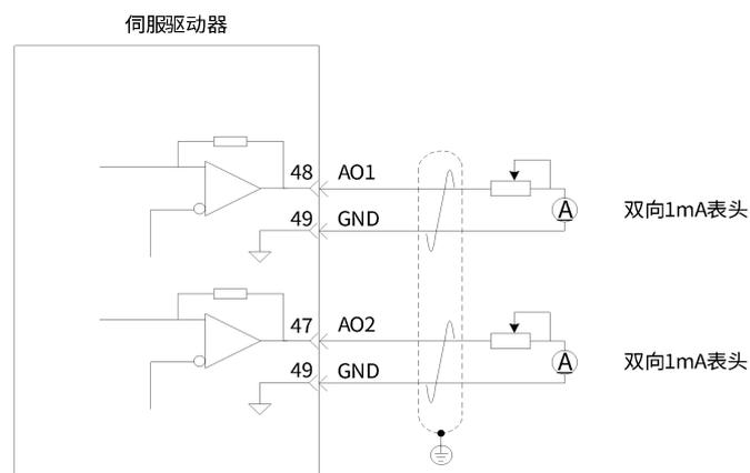
图 2-36 模拟量输出接线示意图
