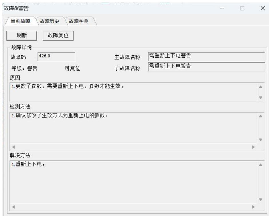
图 3-48 故障诊断
