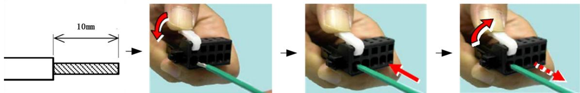
①剥离电线绝缘层, 裸线长度10mm。
