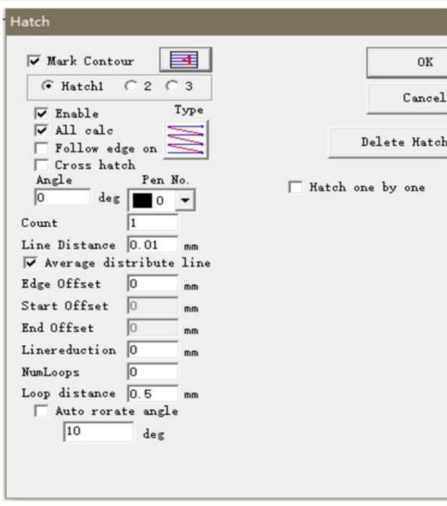
Figure 5-1 Filling parameter setting column
