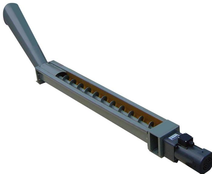
**产品介绍：**可处理金属、非金属材料所切削下来的粉状、颗粒状或较短切屑，可根据需要选择A型：有芯、有集屑槽；B型：有芯无集屑槽；C型无芯、有集屑槽；D型：无芯、无集屑槽。可与其它排屑装置联合使用，组成不同形式的排屑系统。
